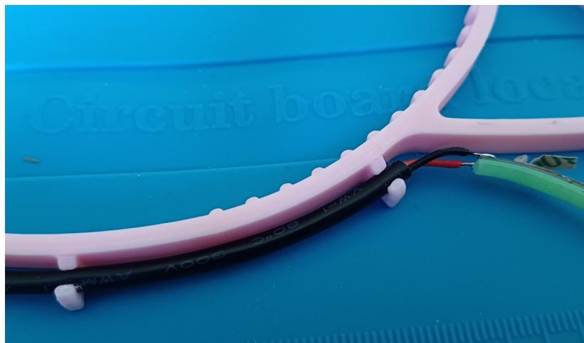
Das LED Band wird nun auf den Rahmen geklebt. Dazu vorsichtig und Stück für Stück, das Papier entfernen und das Band gut an den Rahmen andrücken. Zur Sicherheit kann der Anschluss noch mit einem Tropfen Heißkleber gesichert werden.
